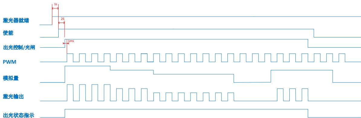
**激光器就绪:** 上电自检没有问题自动输出电源使能8秒后激光器准备就绪，输出高电平24V给机床
